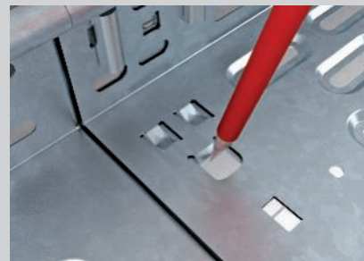
Schraublose Stoßstellenverbindung, nur Umbiegen der Bodenlatten erforderlich.
