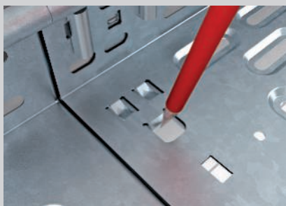
Umbiegen der Sicherungslaschen im Boden.
